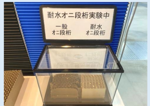
耐水桁の試験を 実際に見ていただきました。
